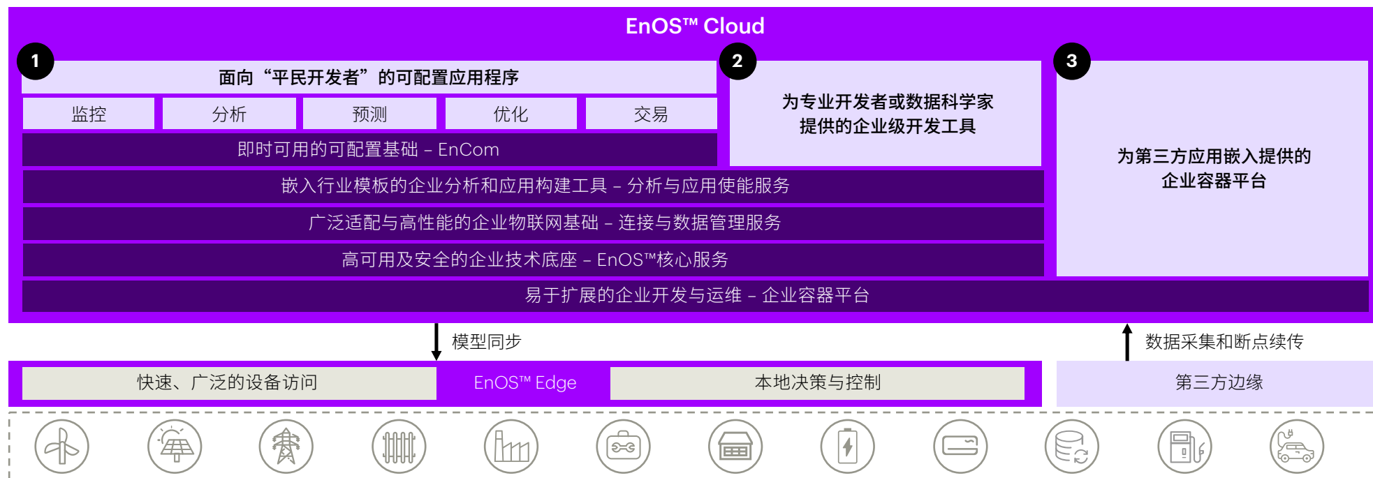
图21. 远景EnOS™智能物联操作系统架构
